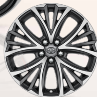
Jante din aliaj de 17", antracit. cu aspect forjat (10 spițe duble) Opțional pe toate liniile de echipare
